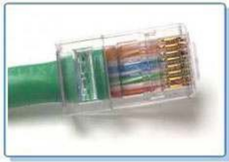
Hasil crimping kabel yang baik
